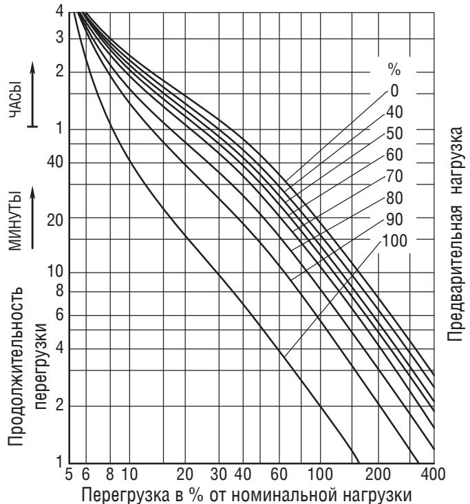
*Рис. 2. Допустимые перегрузки и их длительность при температуре окружающей среды 30 °C*
