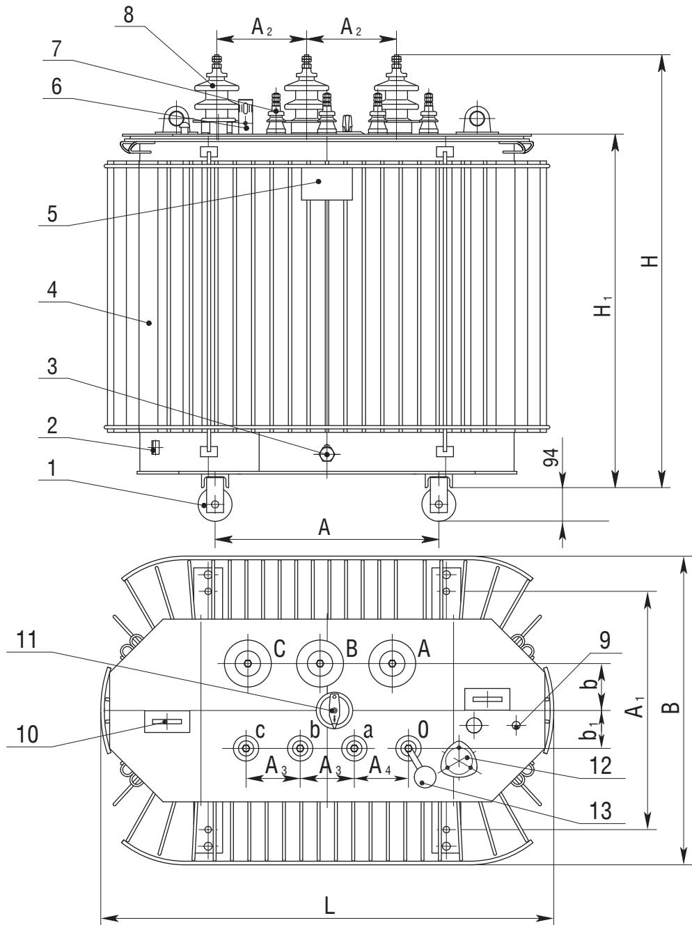
1 – ролик транспортный (устанавливается в трансформаторах мощностью 250 кВ·А и по заказу потребителя в трансформаторах мощностью 160 кВ·А);
