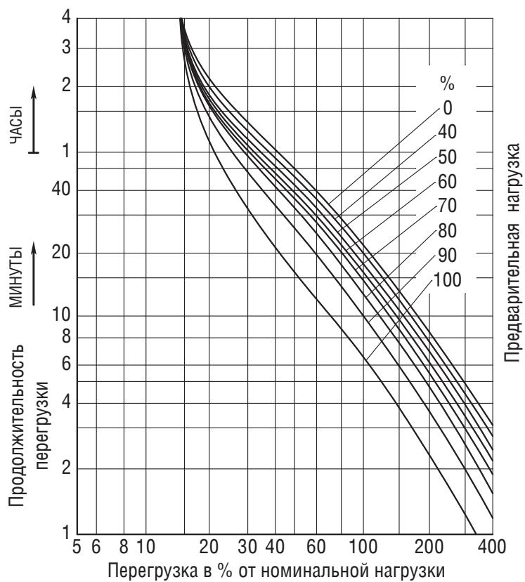
*Рис. 4. Допустимые перегрузки и их длительность при температуре окружающей среды  $10^{\circ}\text{C}$*
