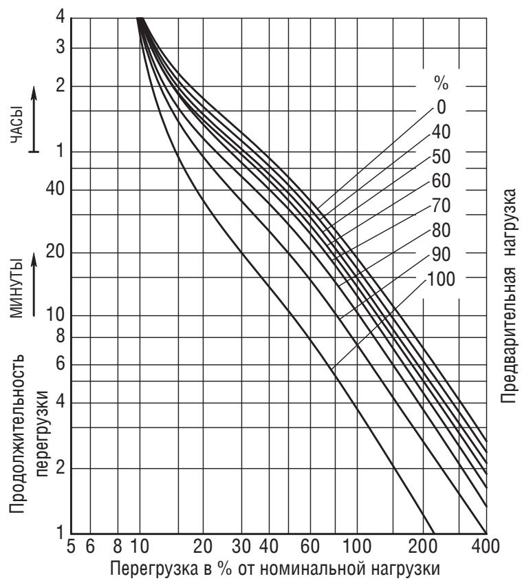
*Рис. 3. Допустимые перегрузки и их длительность при температуре окружающей среды  $20^{\circ}\text{C}$*
