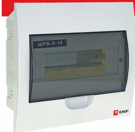
Щиты распределительные пластиковые ЩРН-П, ЩРв-П EKF PROxima предназначены для установки модульной аппаратуры: автоматических выключателей, УЗО, таймеров, устройств управления и т.д. Используются для электромонтажа в жилых, административных, торговых помещениях. Вертикальное открывание дверцы позволяет устанавливать бокс независимо от положения соседних стен. Электрощиты изготовлены из прочного ABS пластика.
